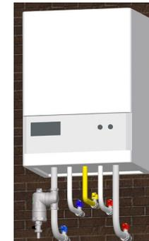
In figura è rappresentata l'installazione di un defangatore sulla tubazione di ritorno con il raccordo orientabile in posizione verticale. Questa configurazione è consigliata se si ha a disposizione spazio in verticale sotto la caldaia.
