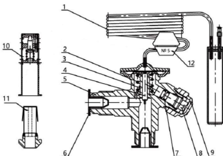
1. Термобаллон с мембранный и капиллярной трубкой.
