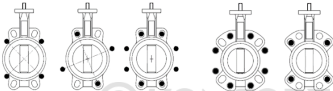
Пример прохода шпилек для установки между фланцами
