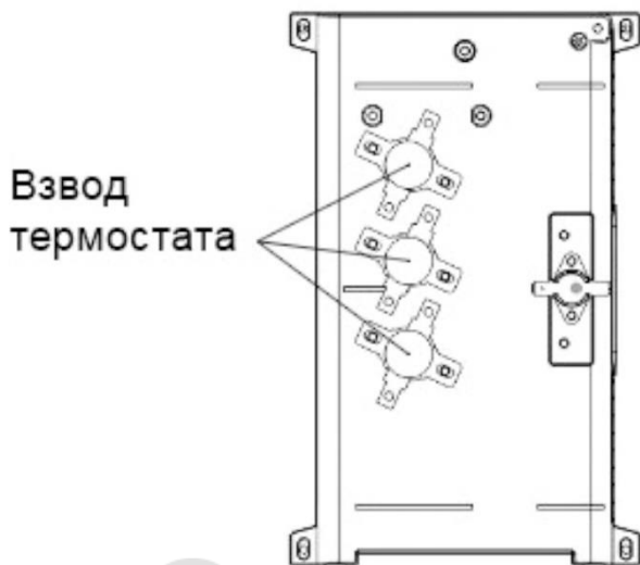
Рис. 26. Ручное восстановление термостатов
