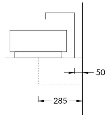
отверстие для установки раковины на столешнице
