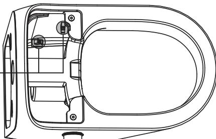
После того, как провод подсветки, провод ручки-регулятора и микроволновый индукционный кабель соединены, расположите провода и вставьте их в зажим для проводов, а затем нажмите и удерживайте зажим для проводов в направлении закрытия, указанном стрелкой. Когда вам нужно вынуть провод, нажмите на зажим для провода в направлении открытия, указанном стрелкой.
