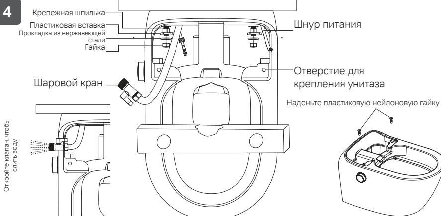
После того, как унитаз будет приставлен к стене, используйте уровень для выравнивания положения унитаза в горизонтальном положении. Затем по очереди наденьте пластиковую вставку и прокладку из нержавеющей стали на крепеж, а затем затяните гайку.
