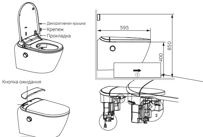
После установки сиденья унитаза на керамику, затяните его крепежным винтом и установите декоративную крышку. После установки извлеките упаковку в направлении стрелки ① на рисунке. Пульт дистанционного управления установлен на расстоянии около 850 мм от земли, что позволяет пользователям легко снимать его.
