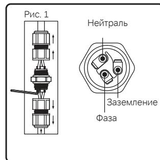
Установите соединительный кабель питания, кабель подсветки, кабель ручки и микроволновый индукционный кабель, как показано на рисунке. Примечание: При подключении необходимо разобрать верхнюю часть водонепроницаемого штекера, проверить, соответствуют ли провод заземления, нейтральный провод и фаза на обоих концах друг другу, и правильно подсоединить провод питания.
