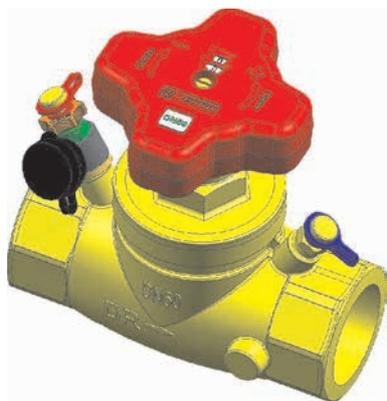
Балансировочный вентиль с измерительными клапанами STROEMAX 4217 GM доступен в размерах от DN 15 до DN 80. Корпусы всех вентилях STROEMAX выполнены из латуни, стойкой к вымыванию цинка, и имеют внутреннюю или наружную резьбу. Возможна модернизация вентиля STROEMAX посредством применения измерительных клапанов различной конструкции. Только путем обеспечения проектного расхода, с помощью балансировочных клапанов STROEMAX, возможно энергоэффективное потребление.
