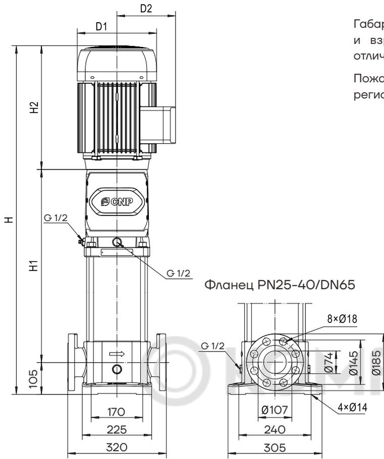
Габаритно-присоединительные размеры однофазного и взрывозащищенного электродвигателя имеют отличия от стандартных значений.
