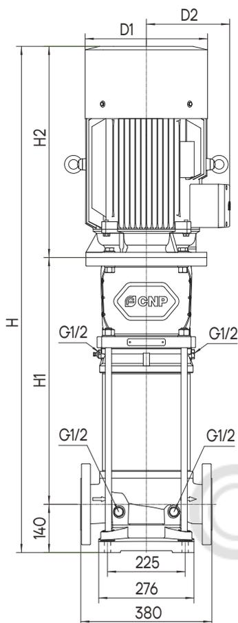
Габаритно-присоединительные размеры однофазного и взрывозащищенного электродвигателя имеют отличия от стандартных значений.
