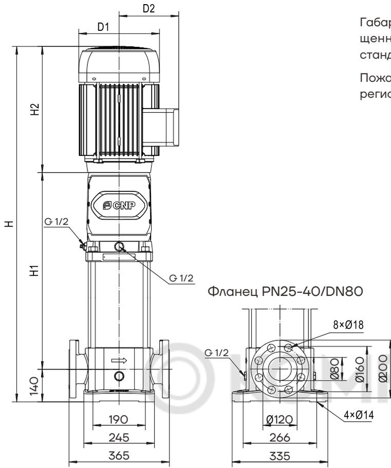
Габаритно-присоединительные размеры взрывозащищенного электродвигателя имеют отличия от стандартных значений.
