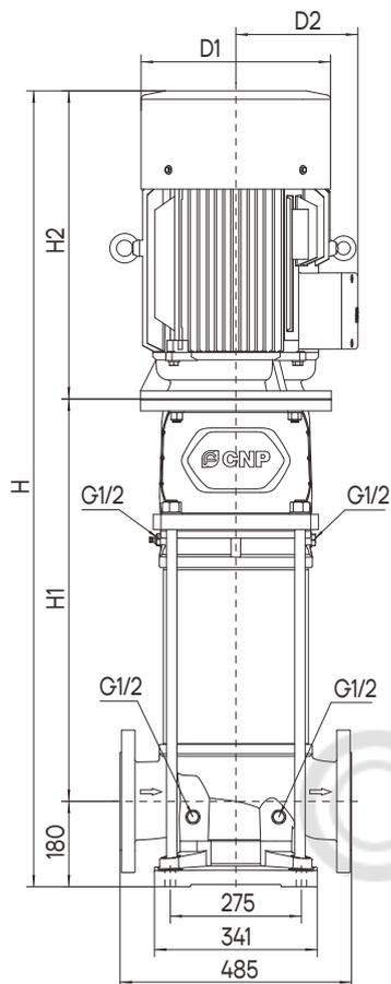
Габаритно-присоединительные размеры однофазного и взрывозащищенного электродвигателя имеют отличия от стандартных значений.
