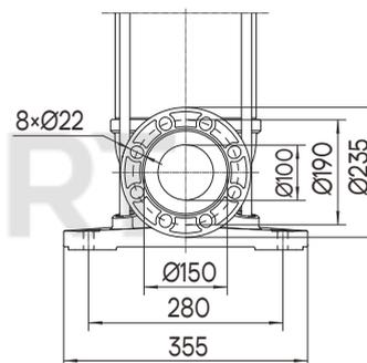
Габаритно-присоединительные размеры однофазного и взрывозащищенного электродвигателя имеют отличия от стандартных значений.
