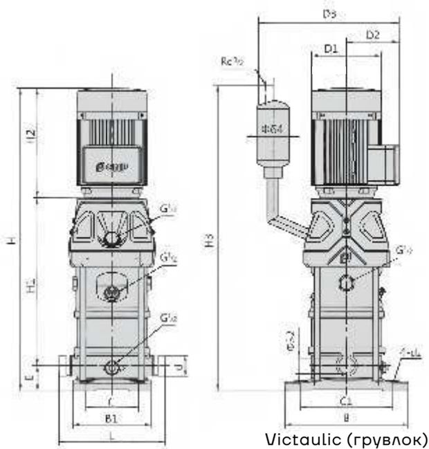
Габаритно-присоединительные размеры однофазного и взрывозащищенного электродвигателя имеют отличия от стандартных значений.
