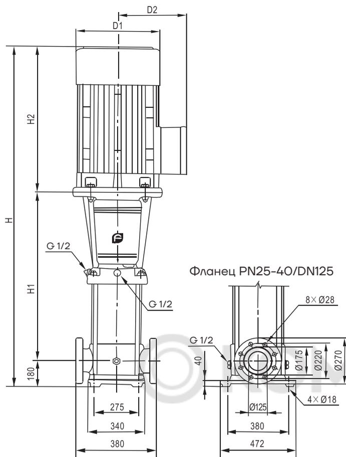
Габаритно-присоединительные размеры взрывозащищенного электродвигателя имеют отличия от стандартных значений.
