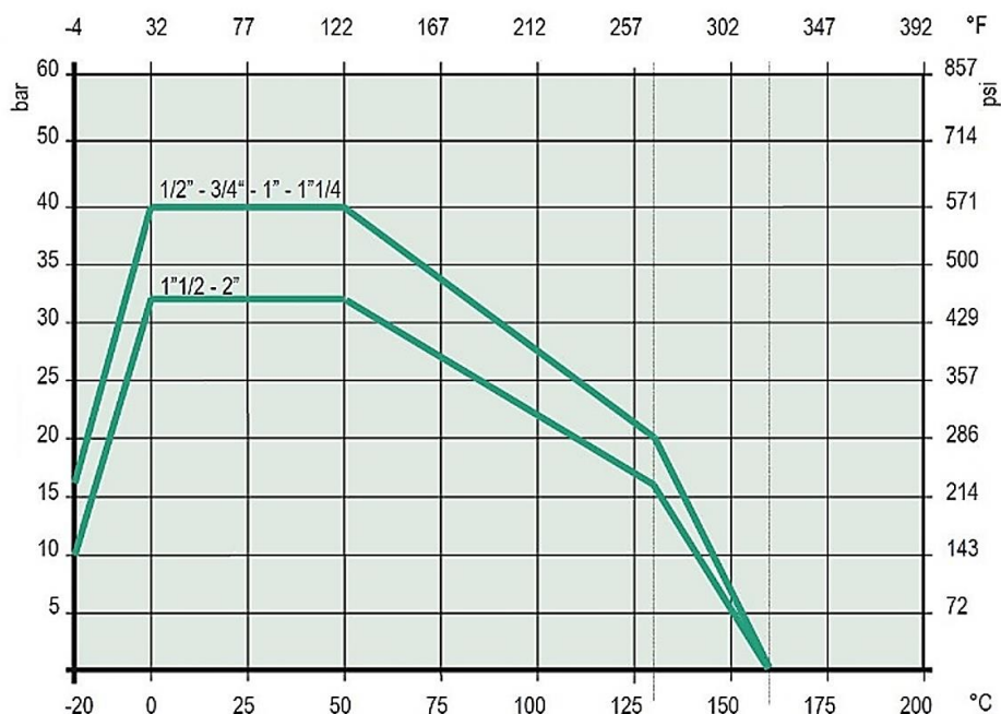
РИС.1.1. ЗАВИСИМОСТЬ РАБОЧЕГО ДАВЛЕНИЯ ОТ ТЕМПЕРАТУРЫ ПЕРЕМЕЩАЕМОЙ СРЕДЫ
