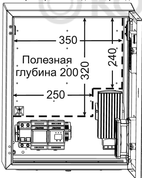
Рисунок 1 – Пространство внутри для установки доп. оборудования
