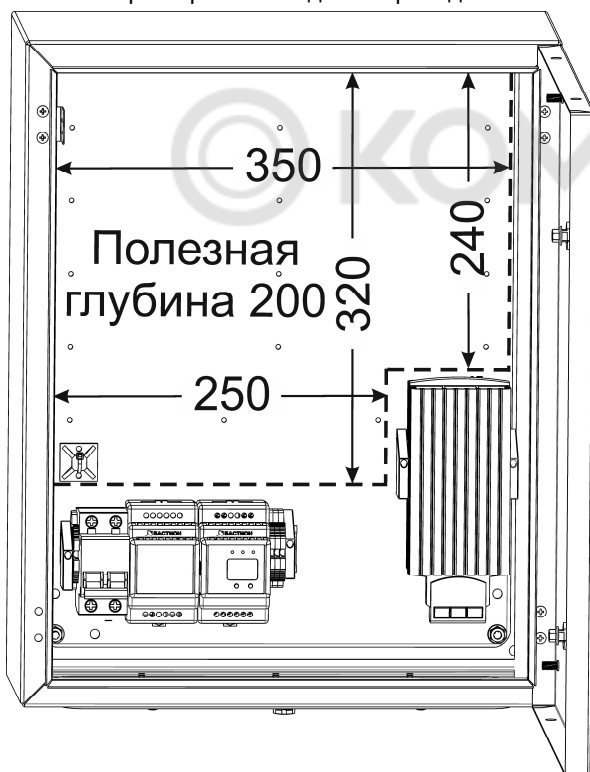
Рисунок 1 – Пространство внутри для установки доп. оборудования
