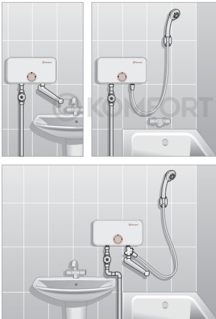
Рисунок 1. Возможные варианты установки ПЭВН.
