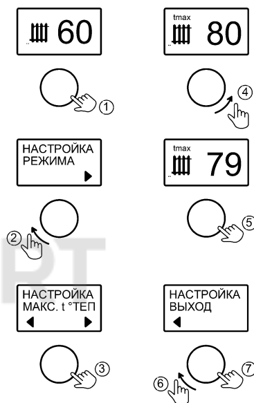
Рисунок 9. Настройка максимальной температуры теплоносителя
