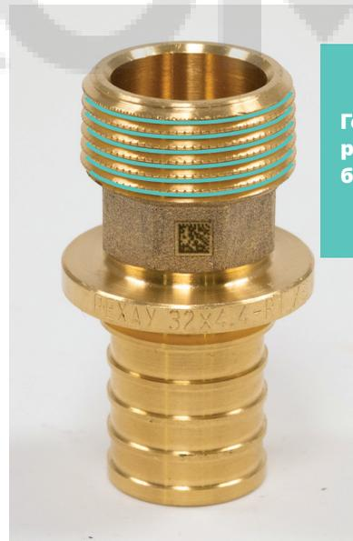
Насечки на наружной резьбе повышают качество уплотнения соединения и ускоряют монтаж.
