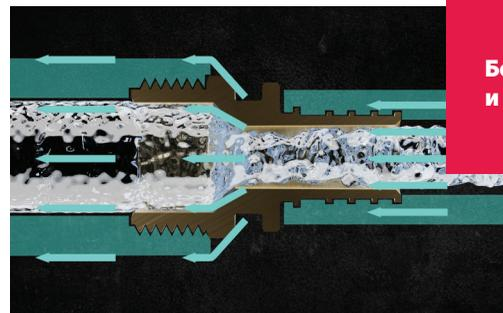
Фитинги PEXAY из DZR латуни используются в системах питьевого водоснабжения, обеспечивая высокое качество воды. Обладают высокой коррозионной устойчивостью, долговечностью и гигиеничностью. Гладкая внутренняя поверхность исключает зарастание и появление отложений.
