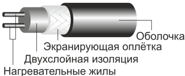
Рисунок 3 - Устройство нагревательного провода.
