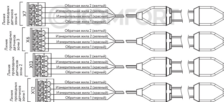
Рис.6 Схема подключения датчиков протечки воды ленточных Stahlmann TWLS к модулю управления Stahlmann HUB
