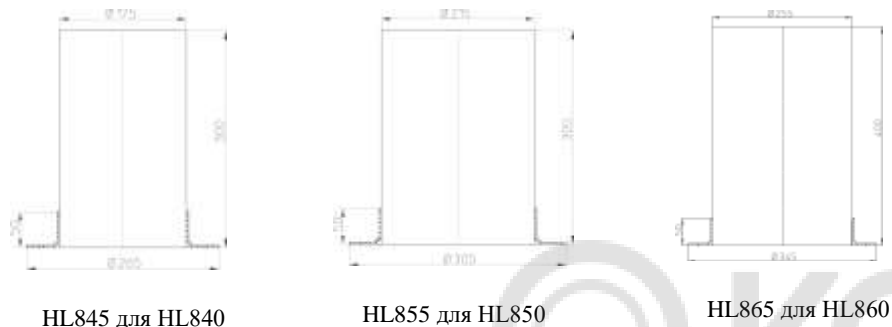
Рис. 2. Закладные элементы для противопожарных муфт.
