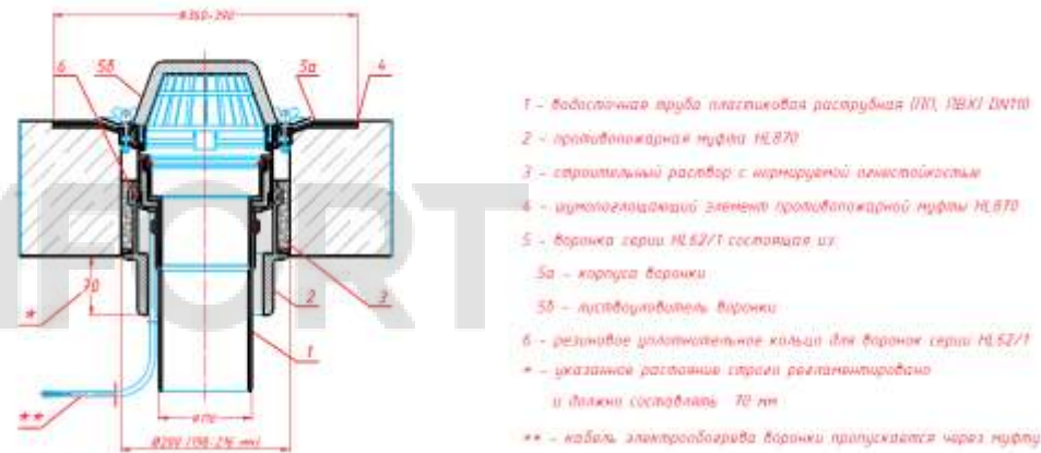
Рис. 4. Схема установки противопожарной муфты HL870 с воронкой серии HL62/1.
