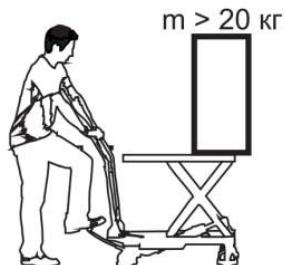
Монтаж шкафов с весом более 20 кг производить с использованием механических подъемных средств, например, подъемных тележек.
