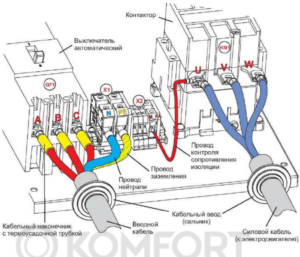
2.4.4 Проверить правильность подключения всех цепей согласно схемы электрической соединений (Приложение В).
