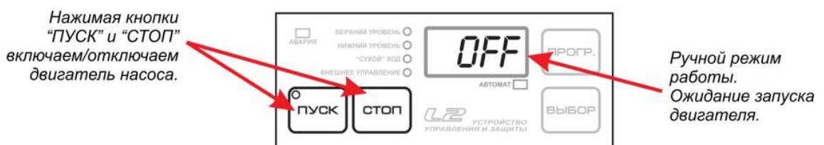
Если при подключении питающей линии не соблюдено правильное чередование фаз, на индикаторе контроллера отобразится мигающая надпись с кодом аварии **Er.01**. Необходимо снять напряжение с автоматического выключателя QF1 и изменить последовательность подключения проводов питающих фаз.
