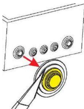
2.4.3.1 Снять прилагаемые кабельные наконечники с автоматического выключателя и контактора.
