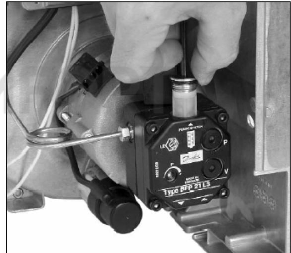
Рисунок 29 – Демонтаж топливного фильтра
