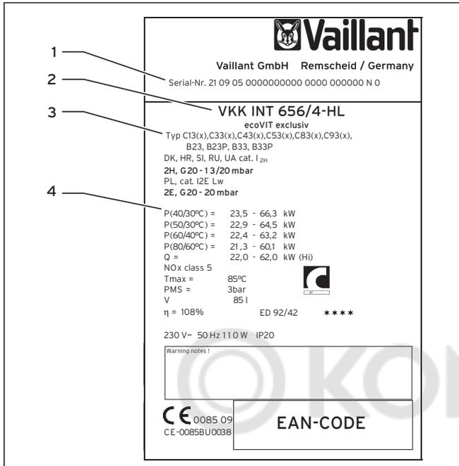
Рис. 1.1 Маркировочная табличка (пример)
