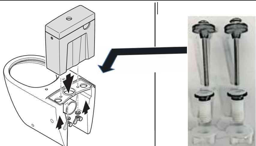
Установите бачок на чашу, затем закрепите с помощью крепежных болтов.
