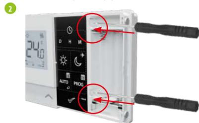
С помощью отвертки вдавите пластиковые выступы, как показано на рисунке, до тех пор, пока не почувствуете сопротивление и выгните переднюю часть корпуса.
