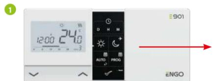
Демонтируйте крышку терморегулятора, как показано на рисунке. Если батарейки внутри - извлеките их.
