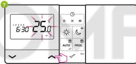
Используя кнопки **▲** или **▼**, установите температуру. Подтвердите кнопкой **✓**. Регулятор перейдет к настройкам следующей программы (максимально можно установить 6 программ).
