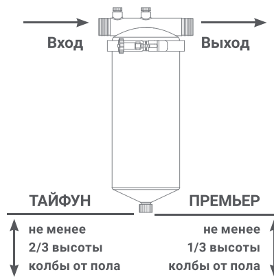
Рис. 1. Подключение фильтра.
