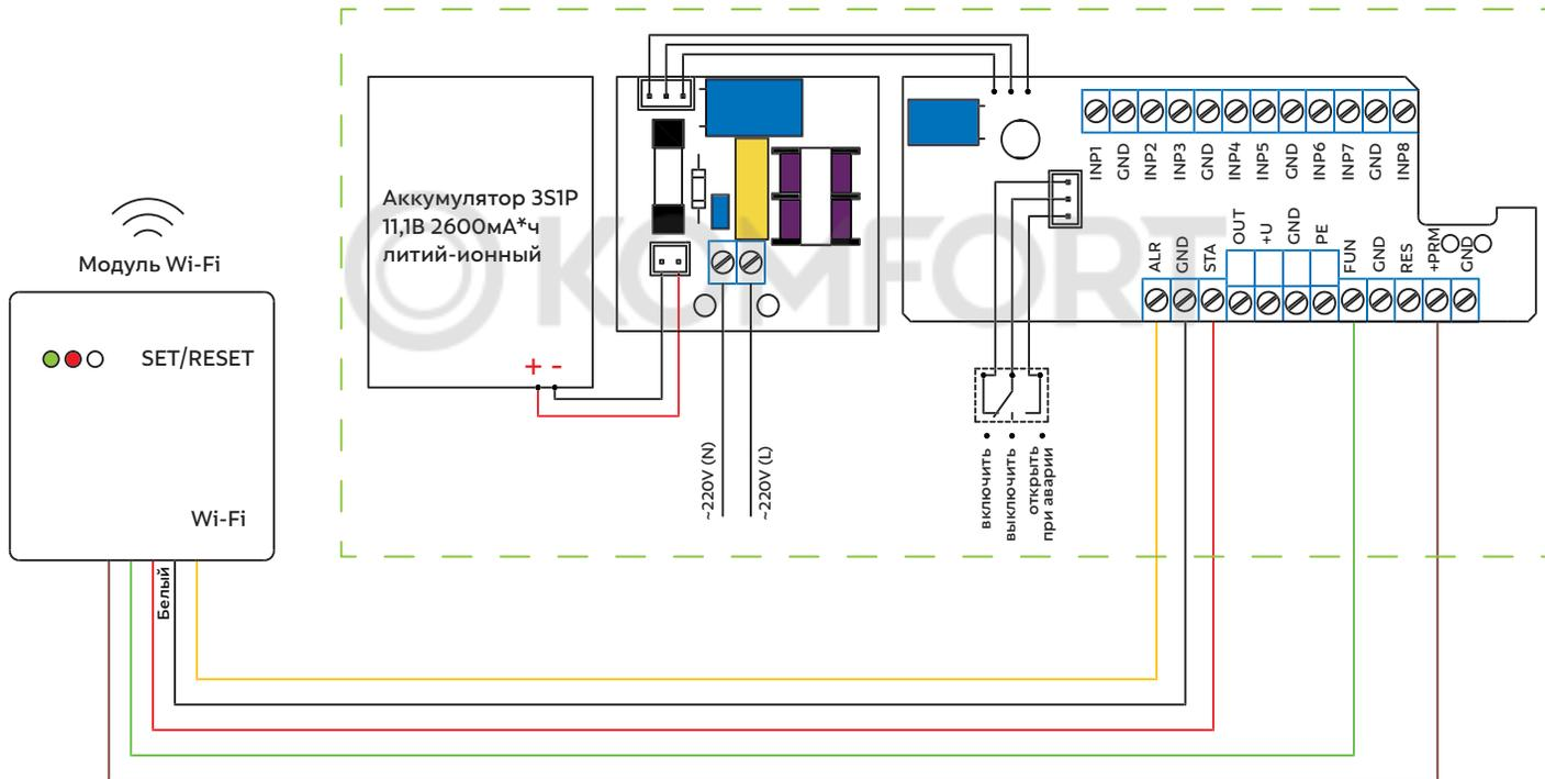
Рис. 3. Схема соединений блока управления с модулем Wi-Fi.
