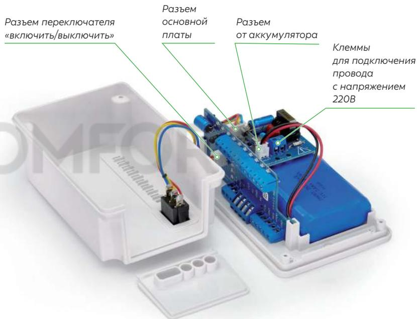
Фото 2. Выносными линиями показаны клеммы для подключения провода (220В), аккумулятора, переключателя «включить/выключить», основной платы управления к плате импульсного блока питания.
