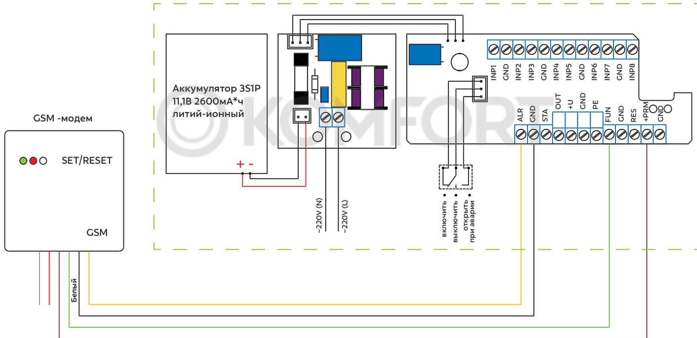
Рис. 4. Схема соединений блока управления с GSM модемом.
