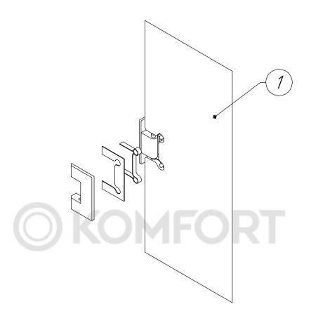
**6.** Примерьте держатель (10). Отметьте на стене место его установки, снимите и сделайте отверстия, уберите мусор, вставьте пластиковый дюбель и установите держатель (10). Закрепите его на стекле.
