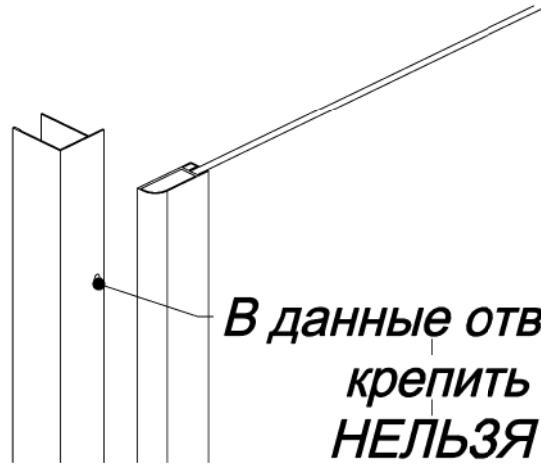
**Обратите внимание! Что крепление через Ц образный профиль ни в коем случае нельзя через готовые отверстия. При закреплении через данные отверстия вы рискуете повредить стекло перегородки. Именно поэтому необходимо просверлить новые отверстия внутри профиля.**
