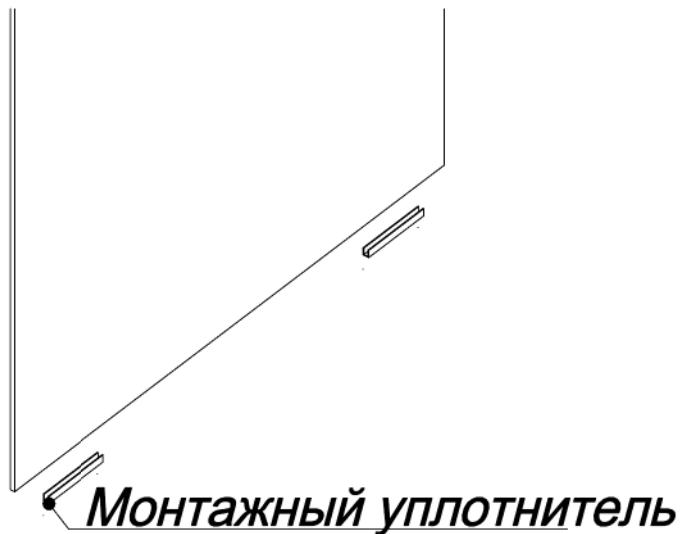
2. Вставьте стекло в профиль ближе к внешней стороне профиля. Ни в коем случае не забивайте стекло по торцовой части, стекло подвержено при таких ударах к разрушению! Вставьте с внутренней стороны профиля уплотнитель елочки. Прижмите уплотнитель ровномерно по всей плоскости профиля.
