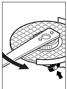
Должным образом затянутую, исправную быстрозажимную гайку можно открутить поворотом кольца с накаткой от руки против часовой стрелки. **Никогда не применяйте для откручивания заклинившей быстрозажимной гайки клеммы, обязательно используйте комбинированный ключ.** Беритесь комбинированным ключом, как показано на рисунке.
