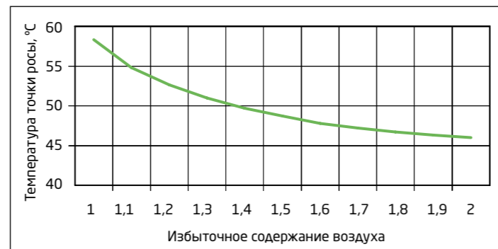
Рис. 2. Зависимость точки росы от избыточного содержания воздуха при использовании в качестве топлива природного газа (метана).
