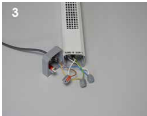
Шаг 3. Подключить провод P-N-PE к клеммам
