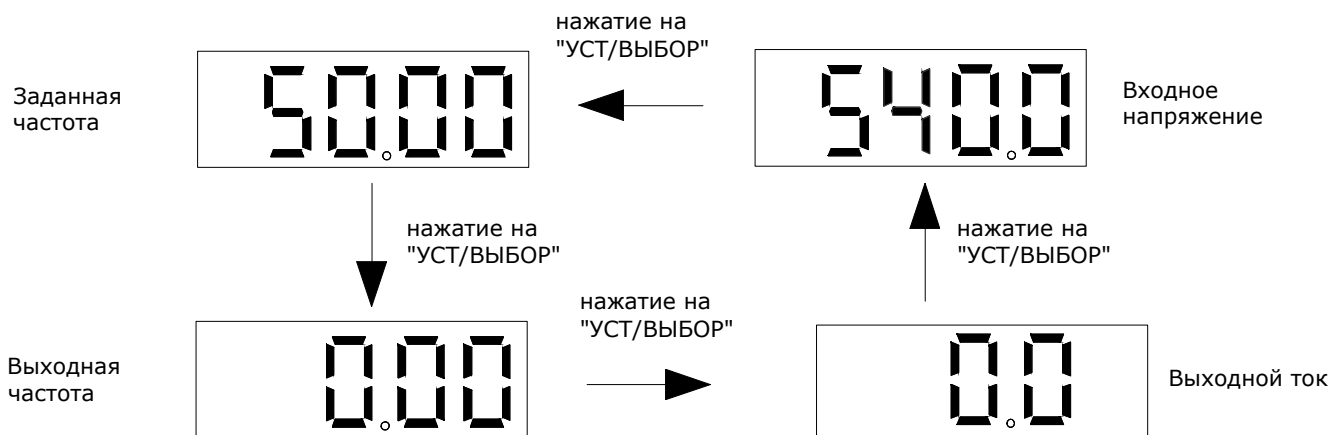
Рисунок 4.2-2 Переключение контролируемых параметров
