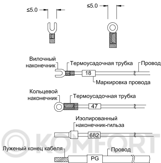
Рис. 5.4.1 Рекомендованный способ подготовки проводов
