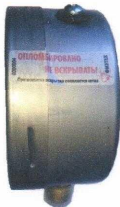
Рисунок 11 – Заводская пломбировка с помощью наклейки
