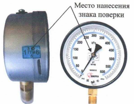
Рисунок 12 – Место нанесения знака поверки
