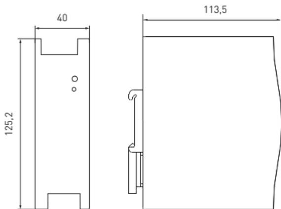
Рис. 3 Габаритные размеры блока питания DR-E-120W-12/24, DR-E-150W-24
