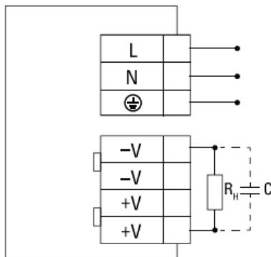
Рис. 1 Схема подключения блока питания
