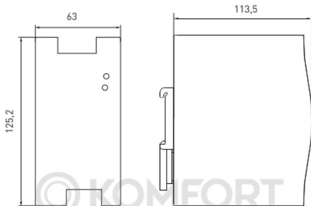
Рис. 4 Габаритные размеры блока питания DR-E-240W-24/48
