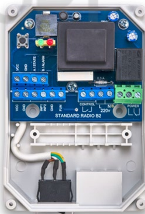
Фото 2. Блок управления GIDROLOCK STANDARD RADIO со снятой верхней крышкой.
