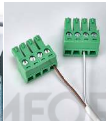
Фото 10. Подключение провода датчика к ответной части разъема электропривода
