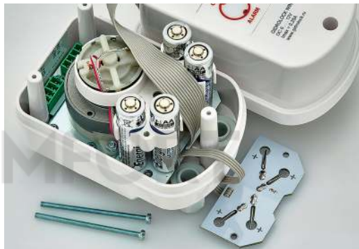
Фото 31. Контактная площадка снята, батарейки могут быть заменены
