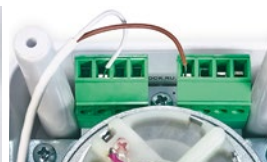
Фото 15. Подключение датчика к электроприводу
