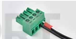
Фото 19. Подключение внешнего блока питания +12 В к ответной части разъема электропривода
