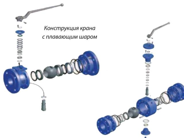
Конструкция крана с плавающим шаром
