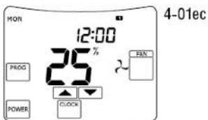
4-01ec Основное окно пульта. Когда вентиляционное устройство работает в соответствии с запрограммированным событием, в верхнем правом углу экрана загорается показание **1 2 3** или **4**. Чтобы изменить установки запрограммированных событий, нажмите **PROG** для входа в программное окно пульта.
