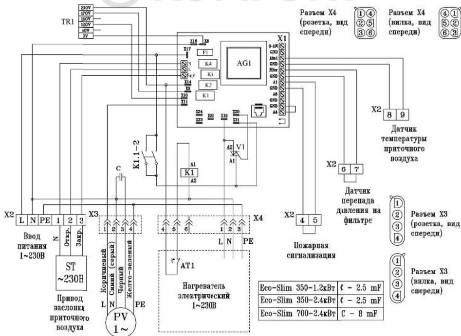
Схема для установок с электрическим нагревателем 2-х фазным.
