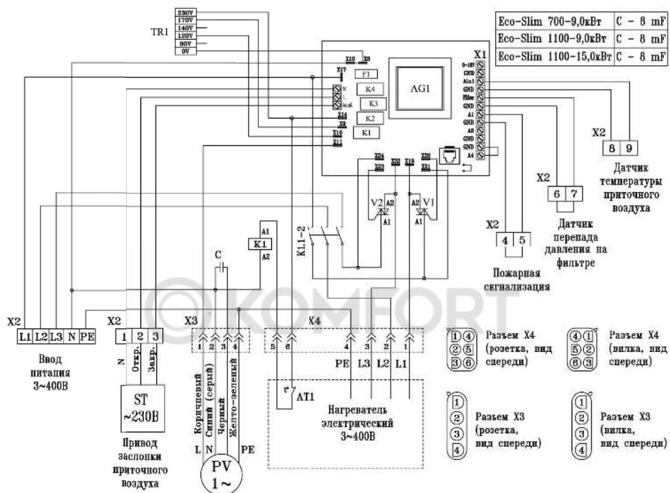
PV – вентилятор приточного воздуха;
