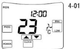
4-01 Основное окно пульта. Когда вентиляционное устройство работает в соответствии с запрограммированным событием, в верхнем правом углу экрана загорается показание **1 2 3** или **4**. Чтобы изменить установки запрограммированных событий, нажмите **PROG** для входа в программное окно пульта.
