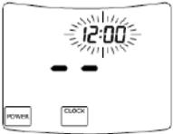
Начальные показания экрана при подключении кабеля управления к плате автоматике в вентиляционном устройстве.
