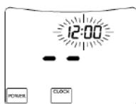
Начальные показания экрана при подключении кабеля управления к плате автоматики в вентиляционном устройстве.
