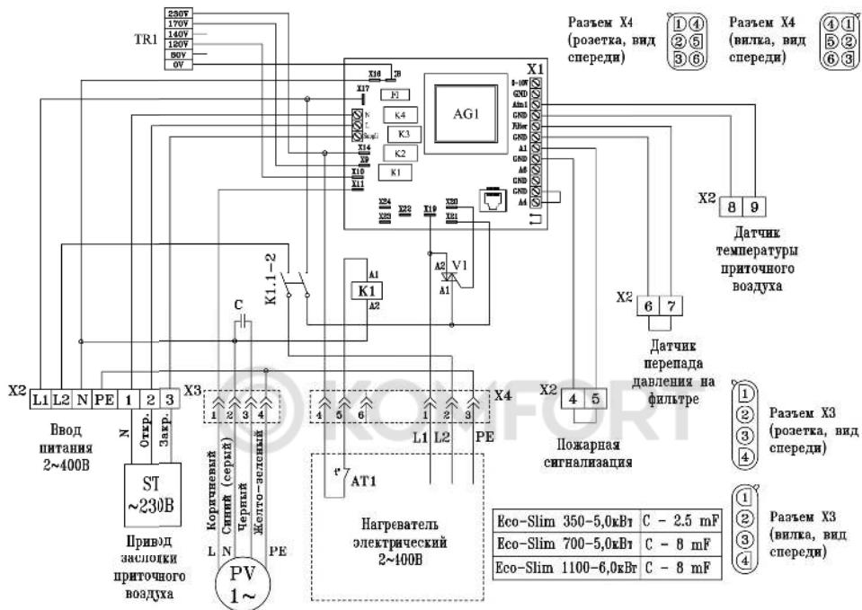
Схема для установок с электрическим нагревателем -3-х фазным.
