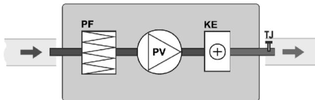
PV – вентилятор приточного воздуха;
