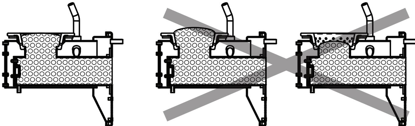
**Рис.13** Настройка уровня топлива при горении
