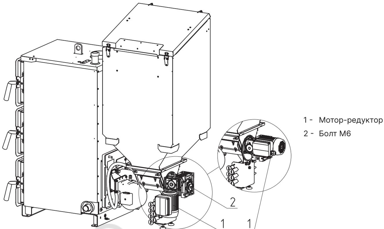
1 - Мотор-редуктор
