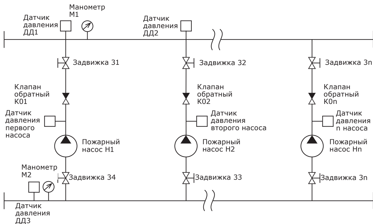
Рис. 3 Общая принципиальная схема установки Hydro-FS-V
