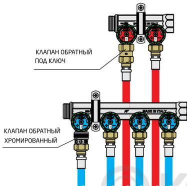
Клапаны обратные пружинные компактные устанавливаются стрелкой на корпусе в направлении потока, как в горизонтальном, так и в вертикальном положении.
