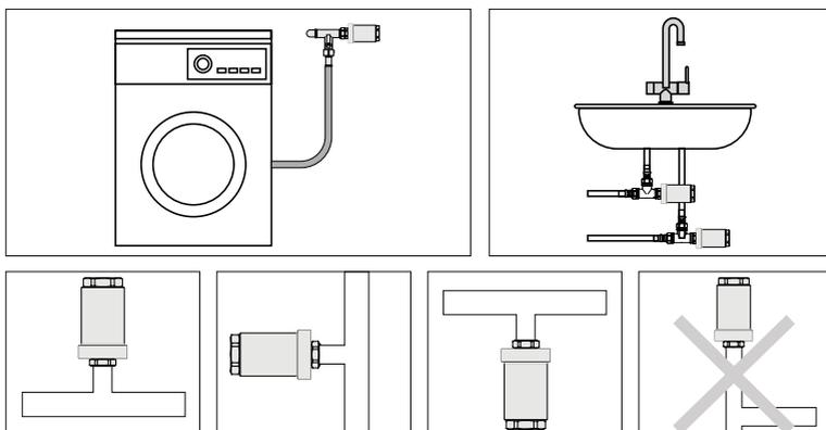
Компенсатор гидроударов может быть установлен в любом положении (горизонтально, вертикально, вверх ногами) на трубопроводах с диаметром до 1 1/4" между устройством, создающим гидроудар, и первым устройством системы, подверженным повреждению от гидроудара (например, между редуктором давления и посудомоечной машиной). Расстояние между компенсатором гидроударов и устройством, создающим гидроудар, не должно превышать 10 погонных метров.
