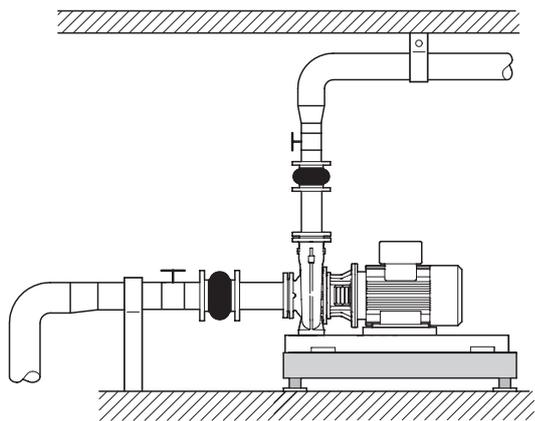
Рис. 11 Монтаж насоса NBV iNOX
