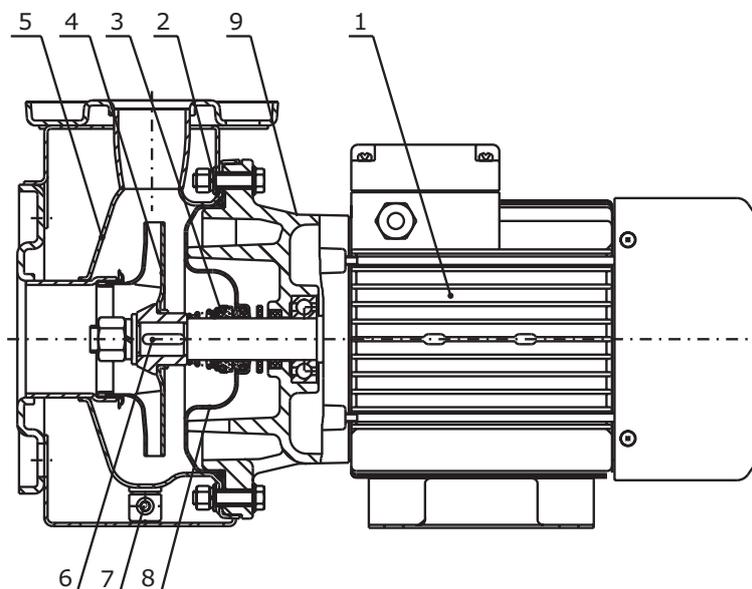
Рис. 1 Насос NBV iNOX в разрезе
