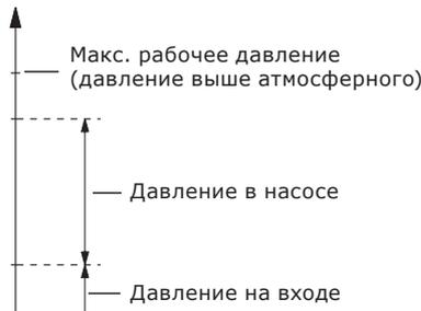
**Рис. 17** Давление в насосе
