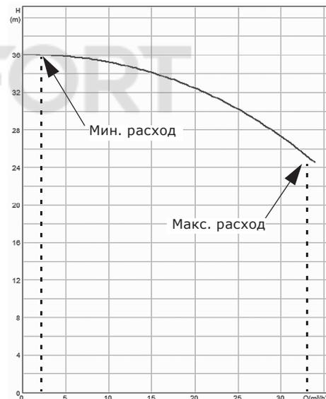
**Рис. 18** Пример с указанием минимального и максимального расхода
