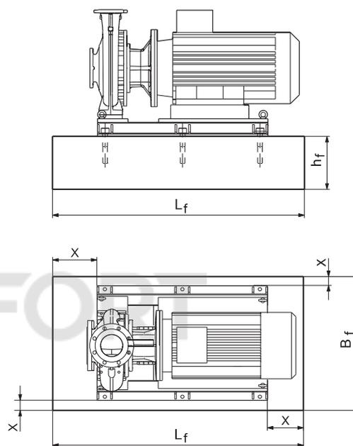
**Рис. 7** Фундамент, X = мин. 100 мм
