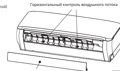
Контроль вертикального воздушного потока
