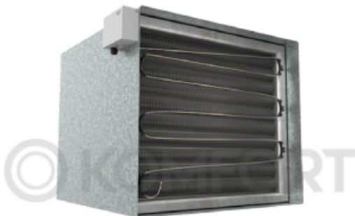
Капиллярная трубка прокладывается с теплой стороны калорифера поперечно или параллельно теплообменным трубам (мы рекомендуем параллельную прокладку) с покрытием всей площади (для защиты калориферов большой площади может понадобиться 2, 3 или более защитных термостатов). Для исключения повреждения капиллярной трубки рекомендуется выдерживать минимальный радиус изгиба 20 мм.
