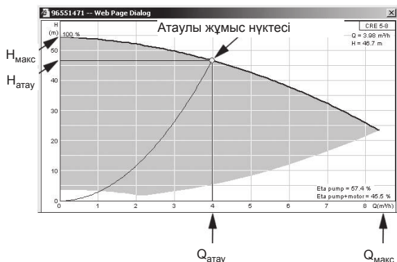
93-сур. Көрсеткіш Q_{атау} , H_{атау} , H_{макс} және Q_{макс}
