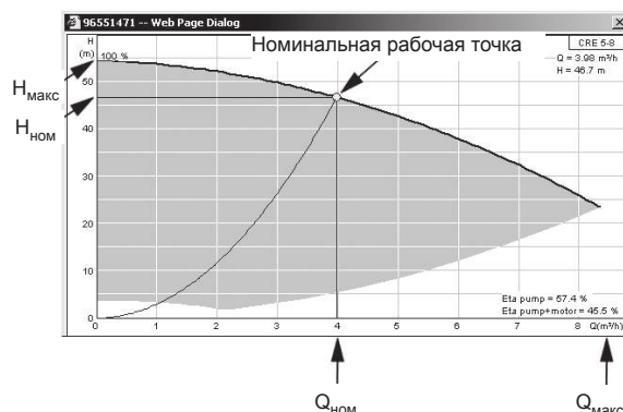
Рис. 93 Показание Q_{ном} , H_{ном} , H_{макс} и Q_{макс}
