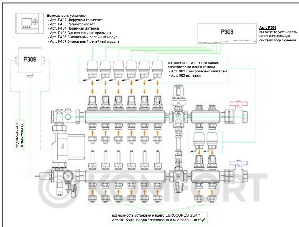
ПРИМЕР МОНТАЖА СЕРВОПРИВОДА НА КОЛЛЕКТОРЕ В СИСТЕМЕ РАДИАТОРГО ОТОПЛЕНИЯ
