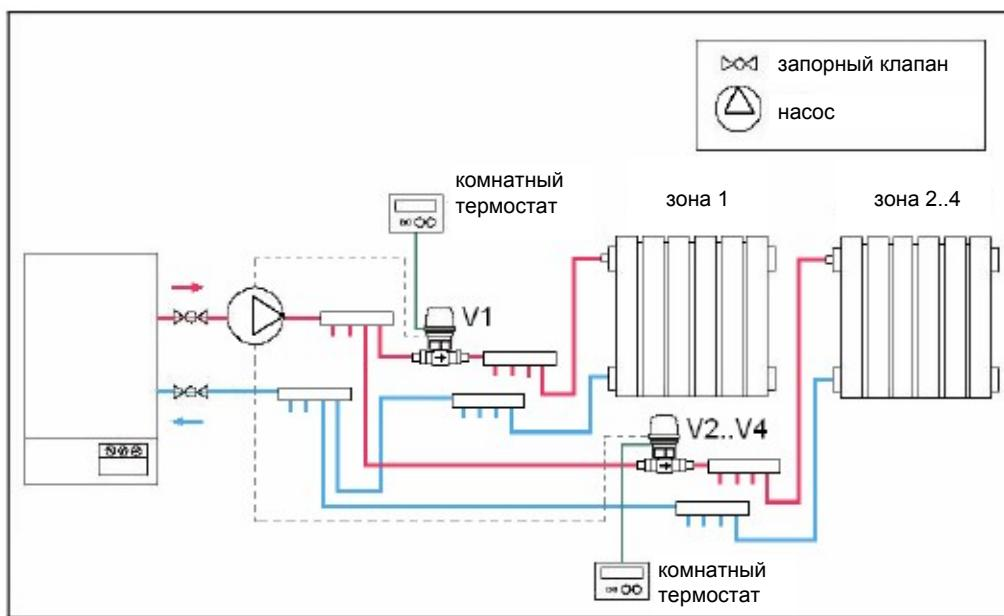
ПРИМЕР МОНТАЖА СЕРВОПРИВОДА НА ЗОННОМ ВЕНТИЛЕ В СИСТЕМЕ РАДИАТОРГО ОТОПЛЕНИЯ
