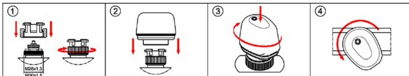
Снять белую защитную крышку с вентиля коллектора. Установить блокировочную группу на боксе и закрутить до конца.
