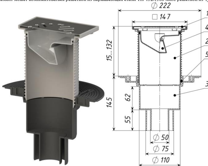
Рис. 1 ТП-310N Трап с незаморажающим запахозапирающим устройством
