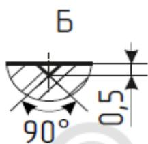
Проточка уплотнительной поверхности
